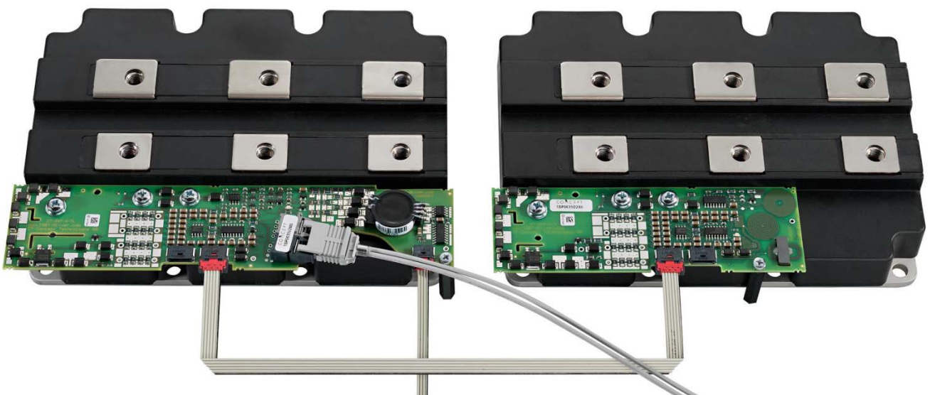
图1 1SP0635V（主板，左）与1SP0635D（从板，右）分别使用螺丝固定到3.3kV IGBT模块上
